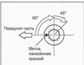
3. Установите механизм регулировки зазора в приводе клапанов.
