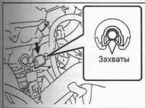
в) Используя спецприспособление, отсоедините топливопровод в сборе.
