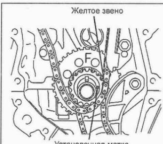
**Примечание:** пластина с меткой со стороны коленчатого вала окрашена в желтый цвет.
