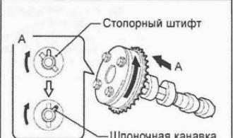
в) Осторожно прижмите звездочку системы VVT к распределительному валу, поворачивайте ее, как показано на рисунке. Продвиньте звездочку системы VVT дальше так, чтобы штифт вошел в канавку.
